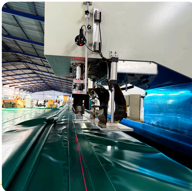
Výroba flexibilní nádrže o objemu 1 000 m 3
