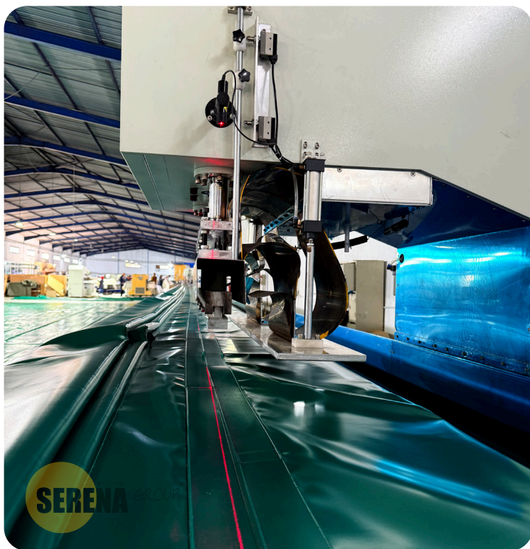
Vysokofrekvenční svářečka se stolem o délce 30 m
