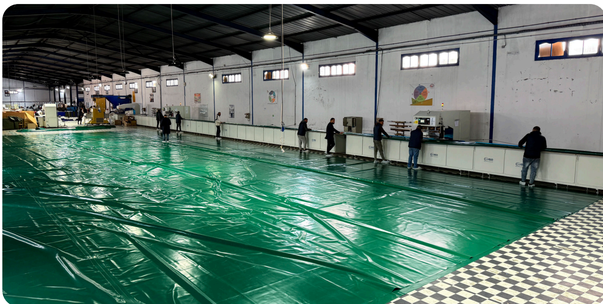
Výroba flexibilní nádrže o objemu 1 000 m 3
